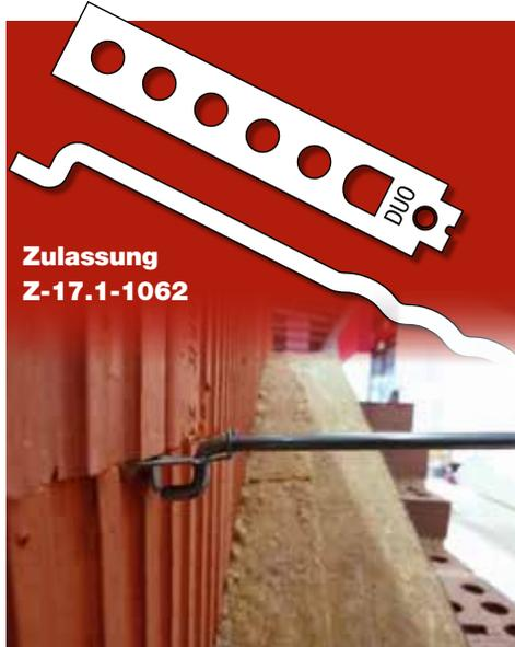
Der Luftschichtanker aus Edelstahl wurde speziell für schmale Schalenabstände von 40 – 150 mm entwickelt und ermöglicht so schlanke zweischalige Außenwandkonstruktionen.
