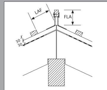
LAF = Lattenabstand zum Firstschnittpunkt (in mm)
