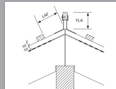
LAF = Lattenabstand zum Firstschnittpunkt (in mm)
