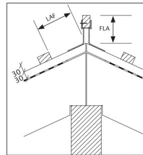
LAF = Lattenabstand zum Firstschnittpunkt (in mm)
