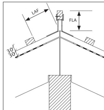
LAF = Lattenabstand zum Firstschnittpunkt (in mm)
