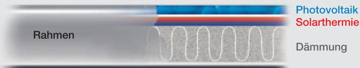
Aufbau des 2Power-Moduls mit seinen drei Schichten, die sowohl Strom als auch Wärme generieren.
