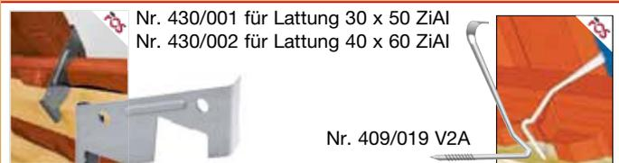
Entsprechend den Fachregeln liefern wir Sturmklammern für die einfache und effektive Windsogsicherung. Alternativ zum Verklammern mit der Lattung oder zum Einschlagen in die Lattung. Korrosionsbeständig durch Edelstahlhidrat 1.4310 (A2) oder ZIAL®-Beschichtung (Korrosionsschutz).
