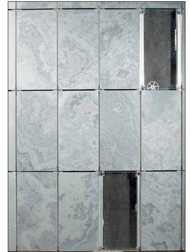
Symmetrische Deckung 600 x 300 mm, vertikal verlegt, auf Alu-UK sichtbar geklammert mit Edelstahl-Befestigungsklammer HE130
