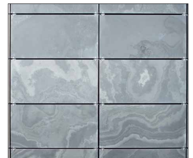
Symmetrische Deckung 600 x 300 mm, horizontal verlegt, auf Alu-UK sichtbar geklammert mit Edelstahl-Befestigungsklammer HE130
